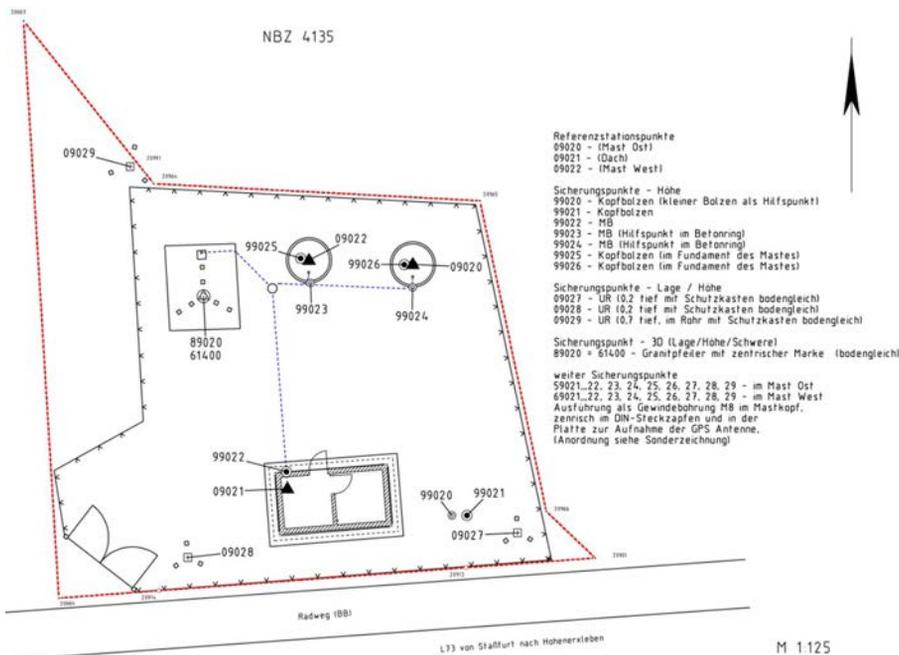
**Abb. 7:** Überwachungsnetz
