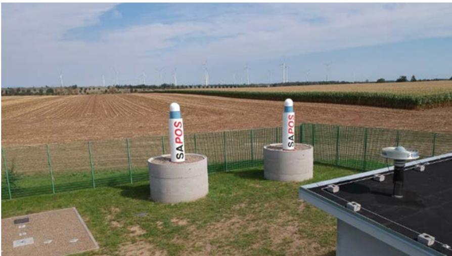
**Abb. 10:** Redundante Stationsvermarkung (Foto:Tino Menge)
