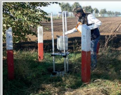
Arbeiten zur Bestimmung der Fallbeschleunigung mit Relativgravimeter CG5
