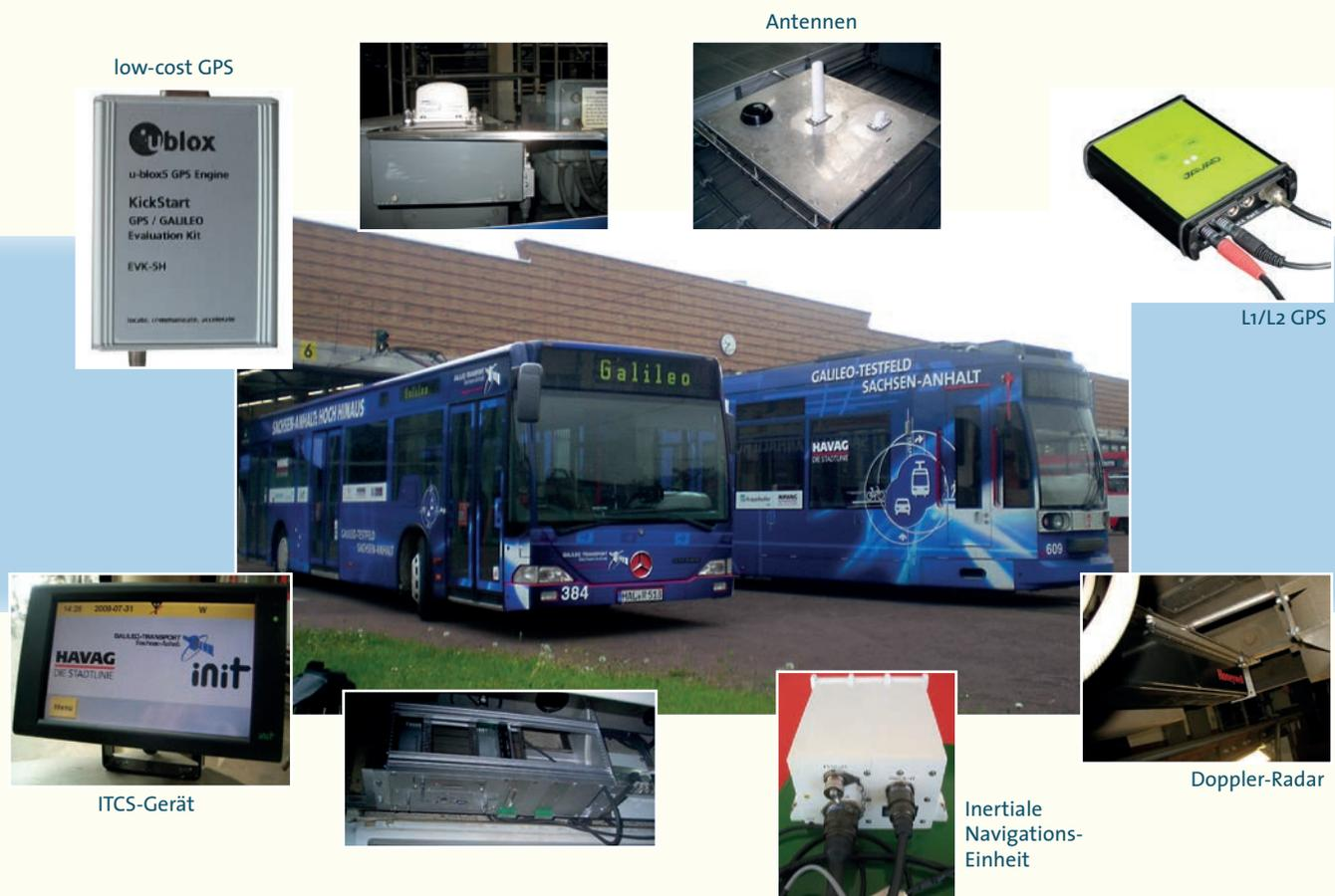
Abb. 1: Galileo-Fahrzeuge mit Ausrüstung im Testfeld Halle (Saale)
