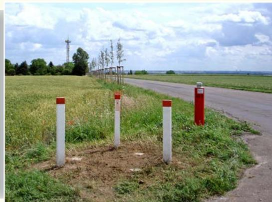
Schutzeinrichtung eines Geodätischen Grundnetzpunktes
