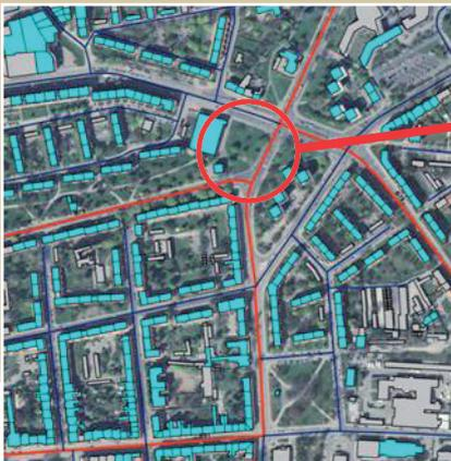
Abb. 1: Modellerstellung des akustischen Ausbreitungsmodells aus LoD1-Gebäudemodellen und mehrfarbigen Orthophotos zur Kontrolle
