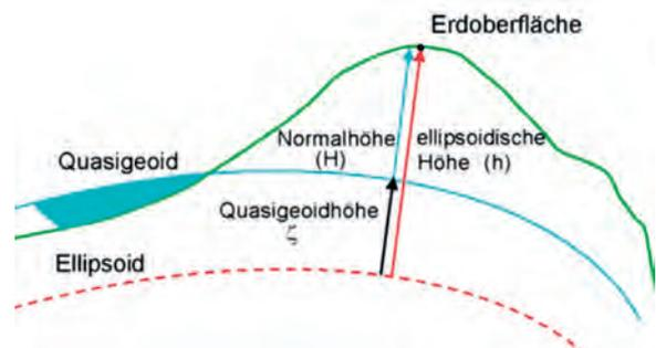
Zusammenhänge zwischen ellipsoidischer Höhe, Normalhöhe und Quasigeoidhöhe, © L VermGeo ST
